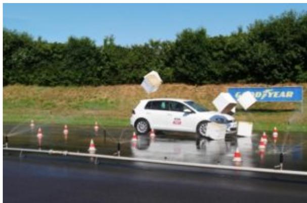
Il KÜS riferisce che i 6 candidati a basso costo hanno mostrato tutti scarse prestazioni anche nell'handling. Nessuno ha grande trazione durante l'accelerazione iniziale, i livelli di grip sono scarsi, il controllo laterale e la trazione nel corso del test sono ridotti. I cambiamenti di carico hanno fatto sì che l'auto rispondesse in modi che avrebbero spinto i guidatori inesperti oltre i loro limiti.
