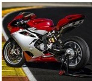
La regina della casa di Schiranna nella versione base R e RR calzerà in primo equipaggiamento i nuovi pneumatici Diablo Supercorsa SP nelle misure 120/70 ZR17 per l'anteriore e 200/55 ZR17 per il posteriore
