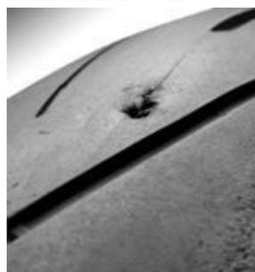
Fig.1: esempio di "chunking" sul battistrada
